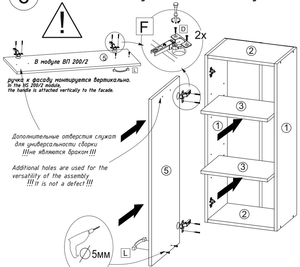
Регулировка петель/Sash loop adjustment
