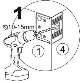
Просверлите заднюю стенку сверлом  $\phi 10-15$  мм в центре прямоугольного отверстия на навесе.
